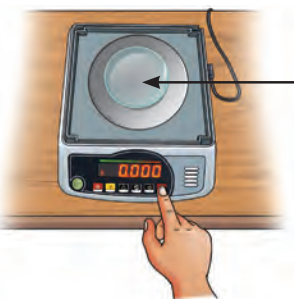
चित्र 9.12 (ख) — वाच-ग्लास रखने के पश्चात तुला को शून्य पर लाएँ
